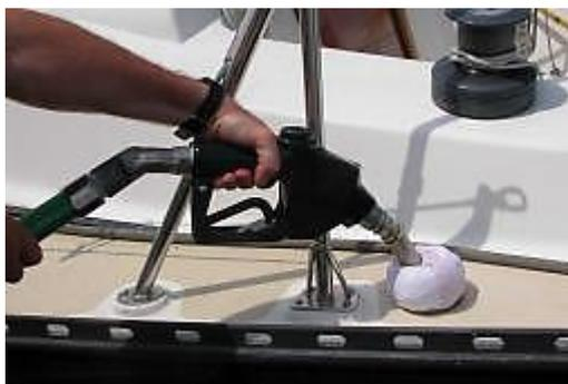
Antes do abastecimento de barcos com propulsão a gasolina e com tanque interno, recomenda-se abrir as portas e tampas de porões para a saída de gases inflamáveis. Averiguar o perfeito funcionamento das ventoinhas dos porões e mantê-las em funcionamento destas durante o processo, evitando formação de gases explosivos.
